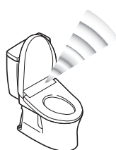
Capteur de présence (Détecte les changements de chaleur)
