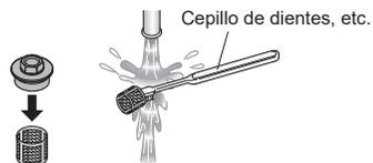
7. Coloque el filtro de suministro de agua en la tapa y, luego, apriete la tapa con la herramienta de apertura/cierre.
