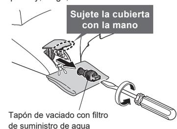
6. Vuelva a instalar el tapón de vaciado con filtro de suministro de agua y cierre la cubierta.
